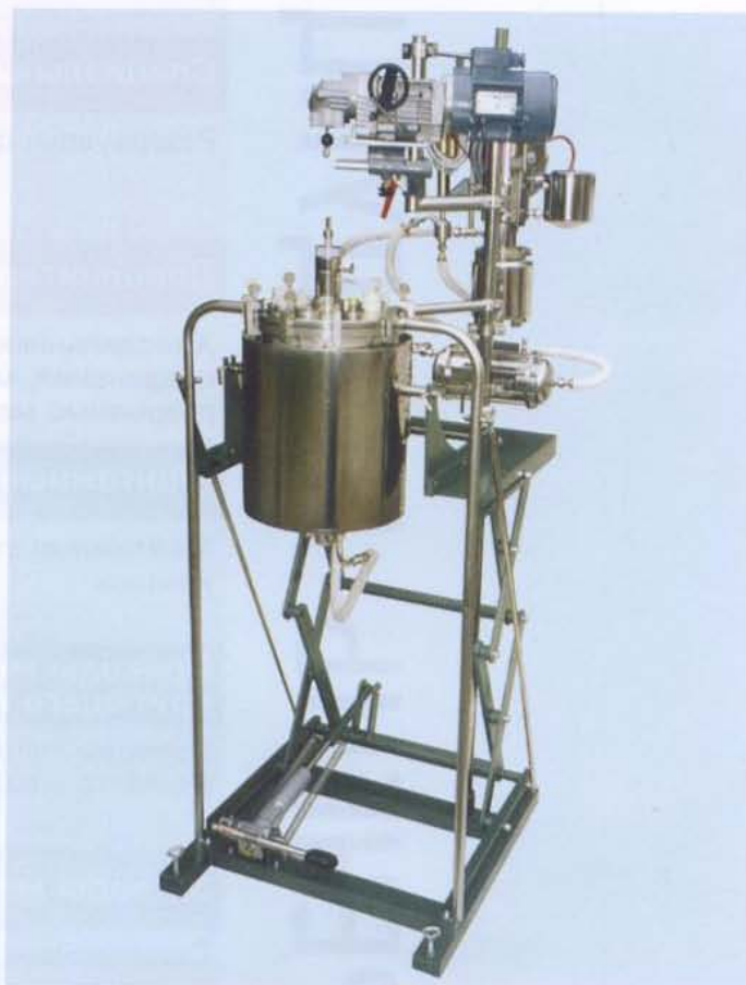
Вакуумный изолированный сосуд 10 л с термостатом и монтажным стандом
