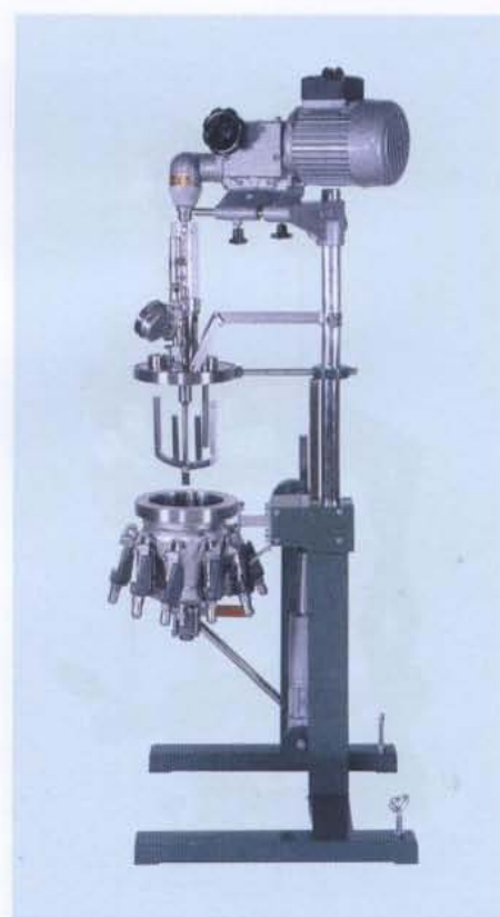
Реактор может быть разобран для чистки
