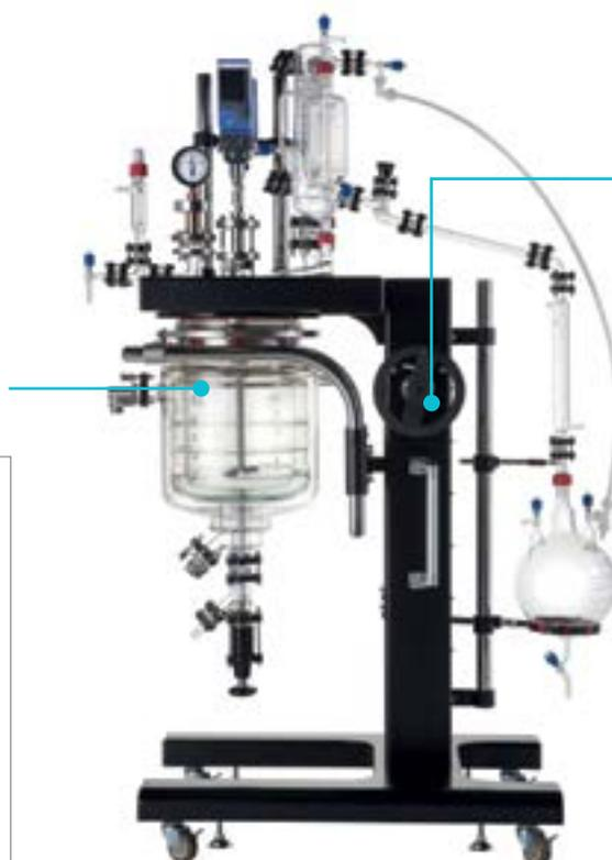
Ручной лифт для подъёма / опускания ёмкости
